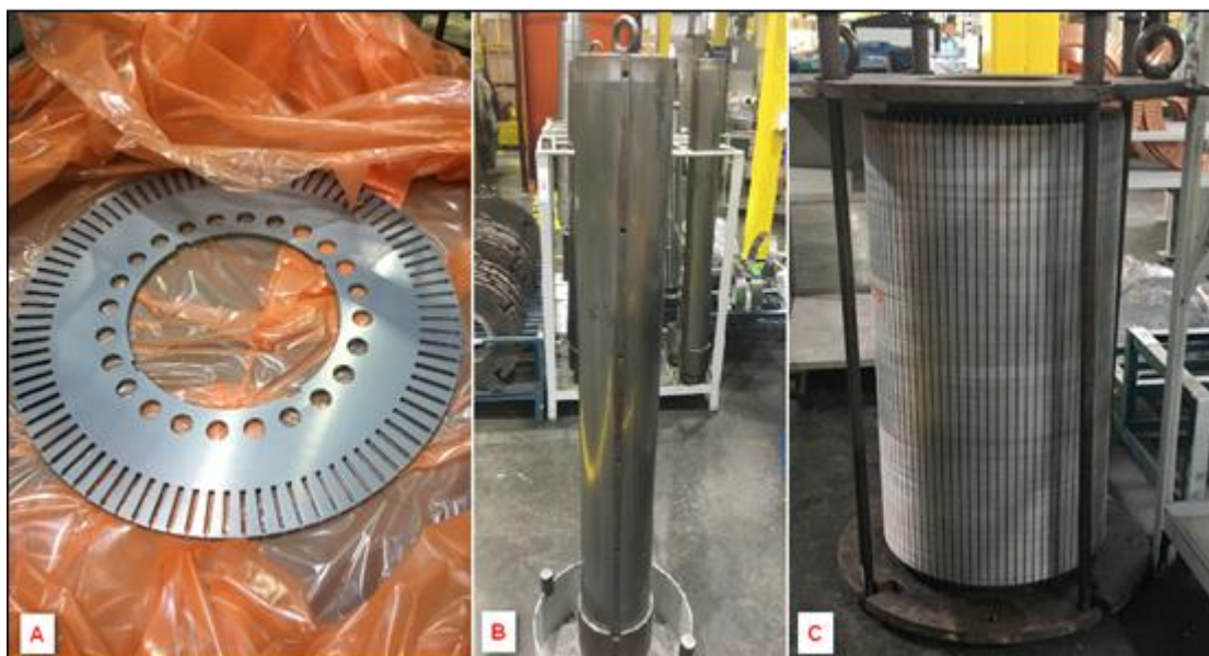
Figura 2 - Chapas do rotor (A); Eixo falso ou dispositivo (B); Pacote de chapas montadas e travadas (C).
