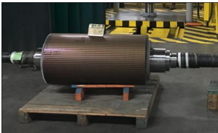
Figura 5 - Rotor prensado e pronto para o próximo processo.
