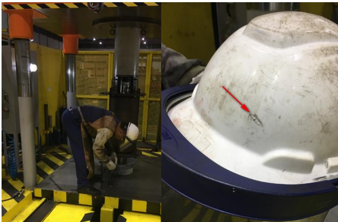
Figura 9 - Operador realizando a operação; Capacete com marca de colisão com o martelo da prensa Calende.
