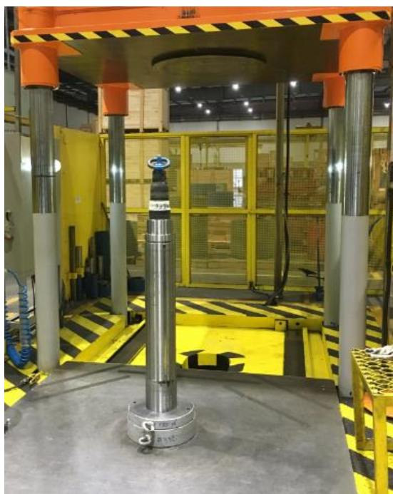
Figura 3 - Eixo preparado para receber o pacote de chapas.
