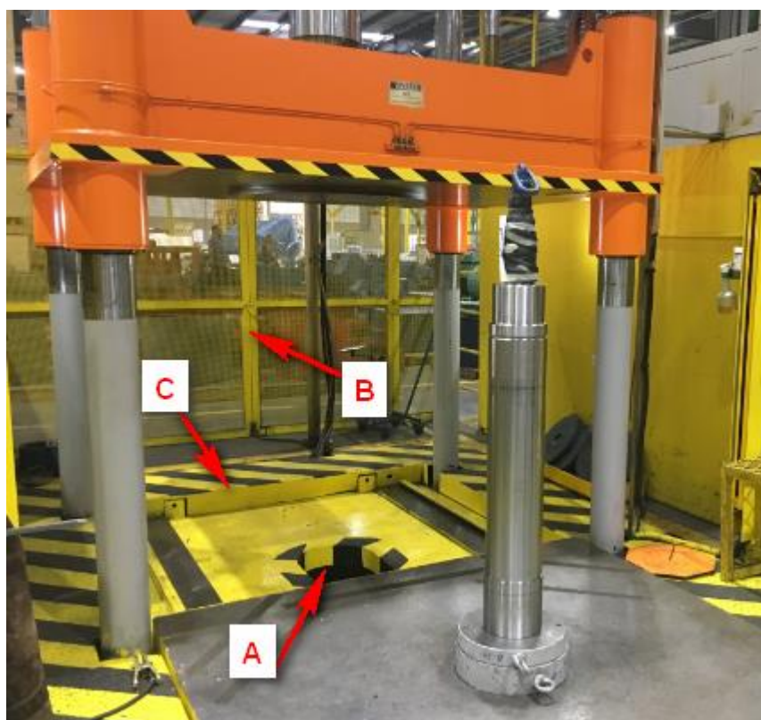
Figura 8 - Fosso (A); Portão (B); Degrau (c).
