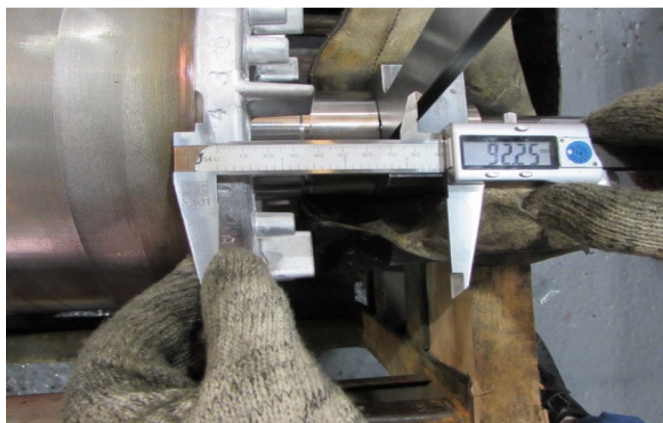
Figura 24 - Medida da cota de prensagem (extremidade da chapa até encosto do rolamento dianteiro)
