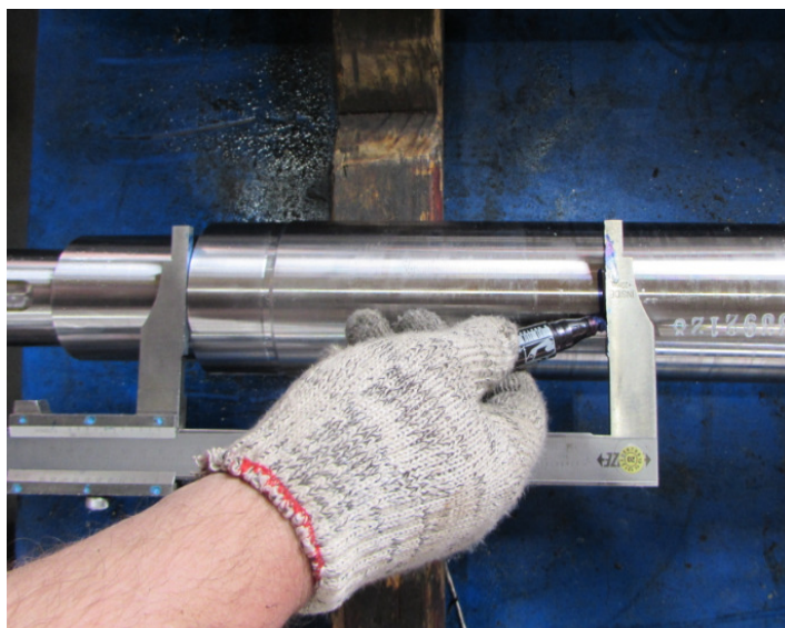
Figura 20 - Demarcação do eixo com pincel atômico
