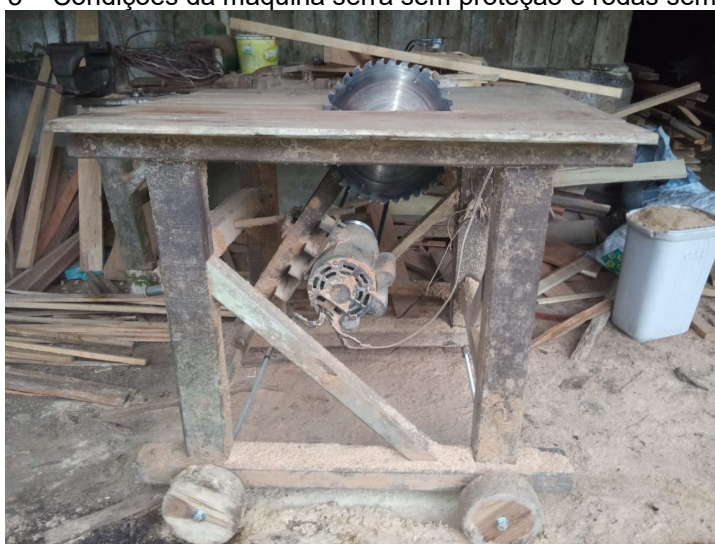
Figura 3 – Condições da máquina serra sem proteção e rodas sem travas.
