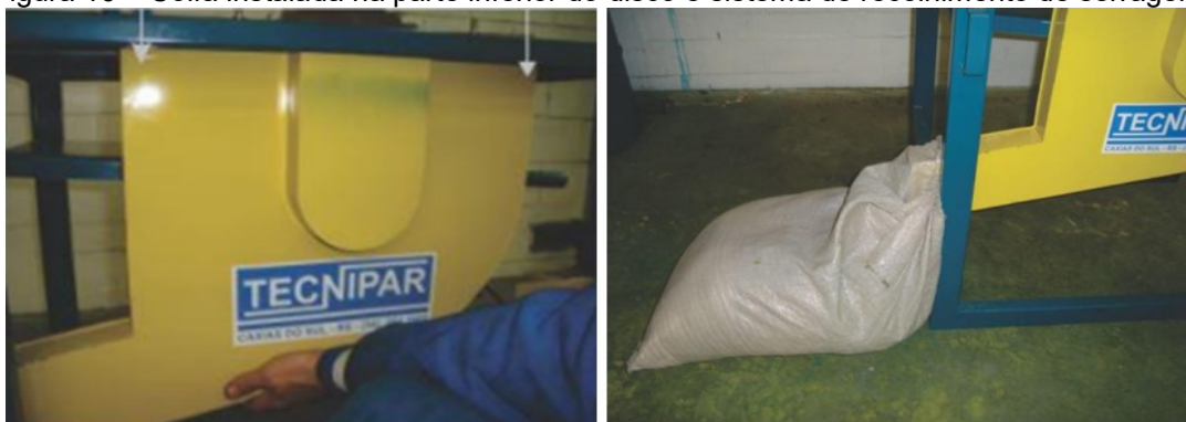
Figura 16 – Coifa instalada na parte inferior do disco e sistema de recolhimento de serragem.
