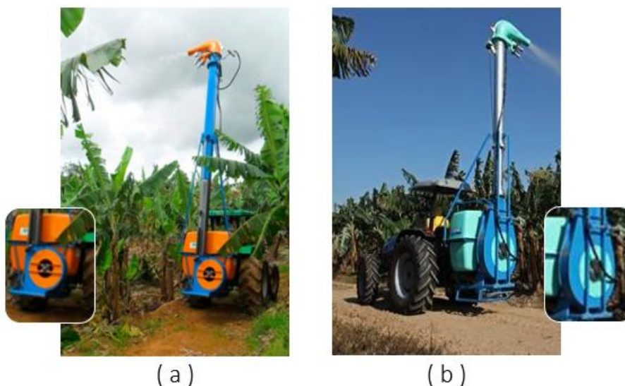
Figura 3 - Tipos de turbinas de canhão bananicultor. (a) Turbina com saída de ar lateral. (b) Turbina com saída de ar central.
