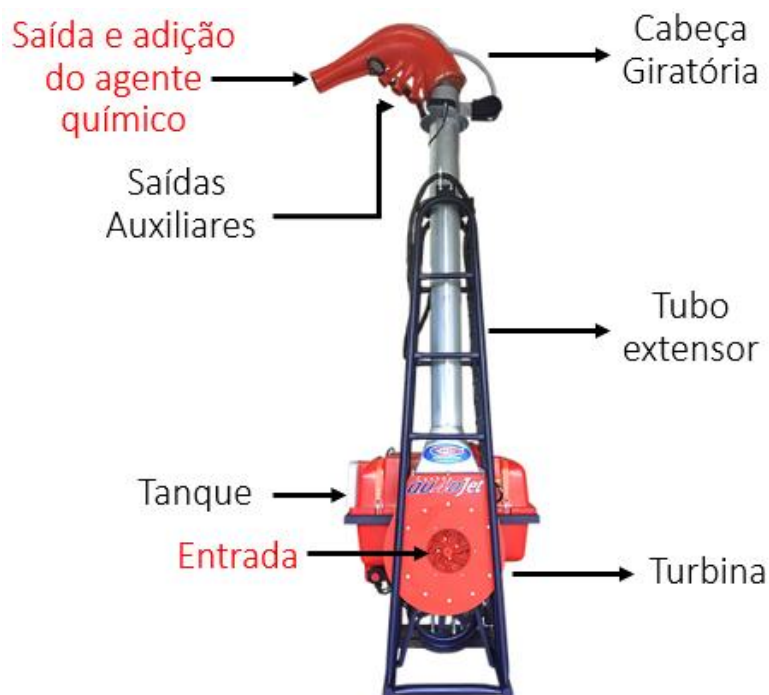
Figura 2 - Principais partes que constituem um canhão bananeiro
