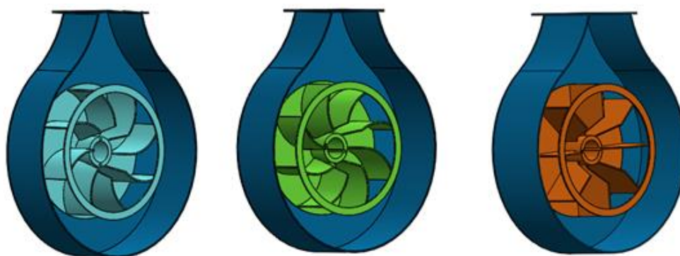
Figura 16 - Ventiladores Utilizados para a análise combinatória com carcaça e saída de ar central. (a) CC/VCE – Ventilador radial de pá helicoidal Esquerda. (b) - CC/VCD Ventilador radial de pá helicoidal Direita. (c) - CC/VPR Ventilador radial de pá reta.
