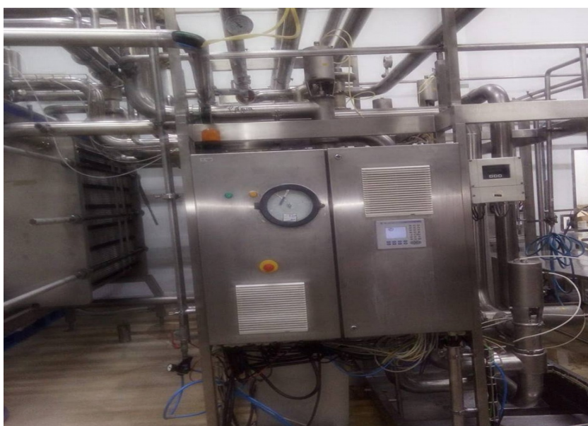
Figura 2: Pasteurizador com trocador de calor a placas.
