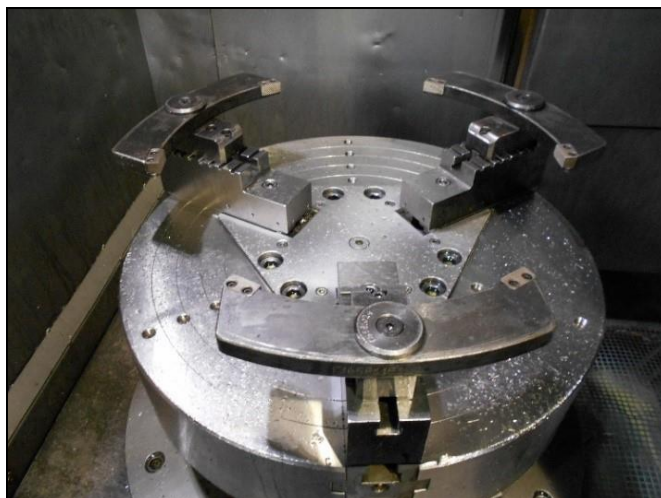
Figura 24 – Placa com seis pontos de fixação
