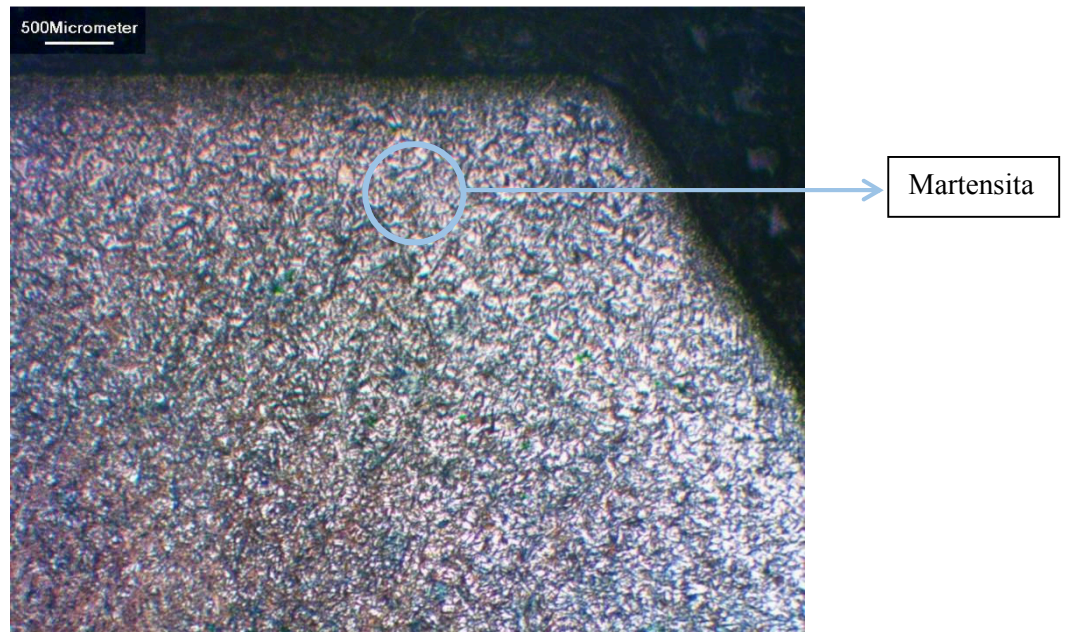
Figura 23. Amostra 2: escala de 500 \mu m, ampliação 200X.
