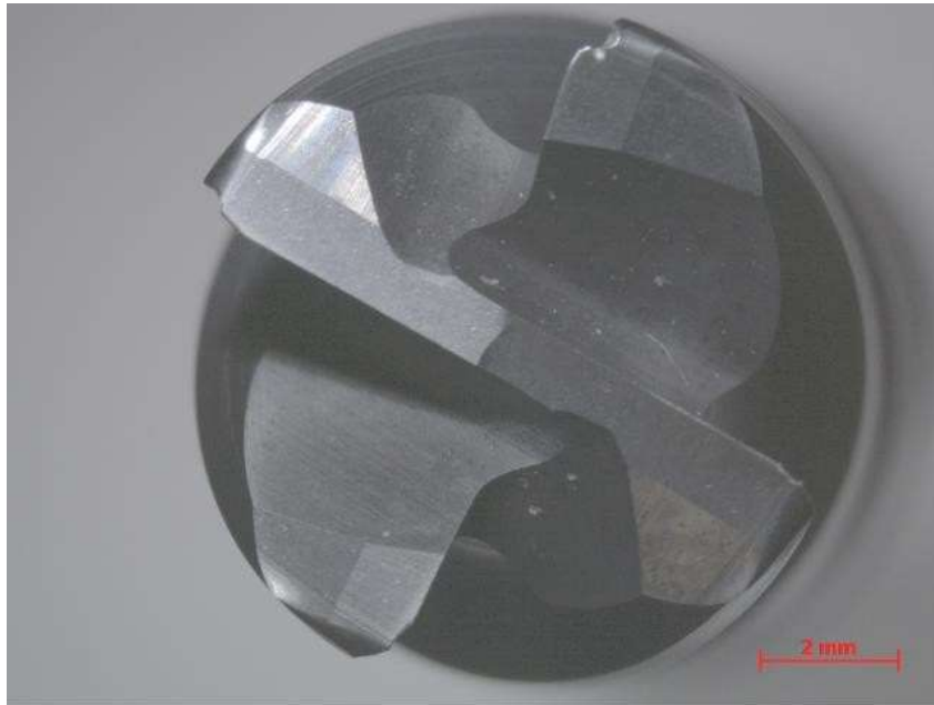
Figura 23 - Fotografia da fresa após o primeiro passe na trajetória laceform.
