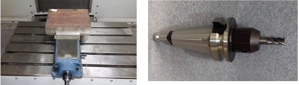
Figura 17 - Foto do método de fixação da amostra e da ferramenta.
