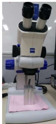
Figura 19 - Microscópio Estereoscópio Carl Zeiss modelo Stemi 4000t e suporte desenvolvido para medições.
