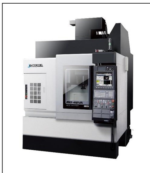
Figura 13 – Centro de Usinagem Okuma
