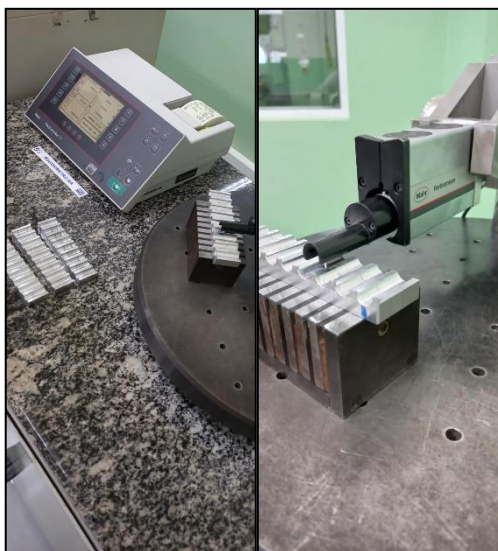
Figura 16 – Rugosímetro MAHR, modelo perthometer S2.
