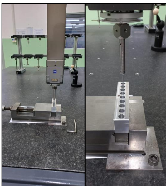
Figura 15 – Máquina tridimensional ZEISS, modelo ACCURA
