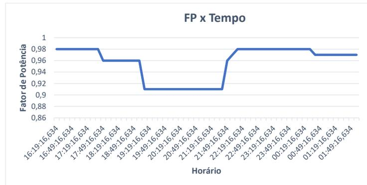
Figura 14: Gráfico de comportamento do fator de potência trifásico no tempo.
