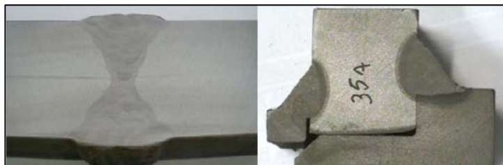
Figura 15 - Macrografia Fonte: Colpaert (2008)
