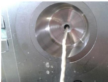
**Figura 22 - Sistema de injeção direta centralizada**
