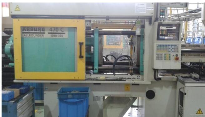
**Figura 27 - Máquina injetora com sistema de visualização de forças efetivas.**
