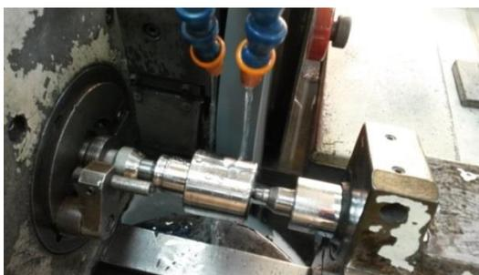
**Figura 17 - Usinagem de acabamento dos postigos machos utilizando o método de retificação cilíndrica**
