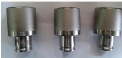
**Figura 20 - Postigos com acabamento superficial erosionado**
