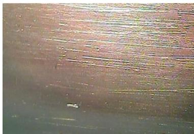
**Figura 43 - Topografia da superfície moldante com acabamento polido.**
