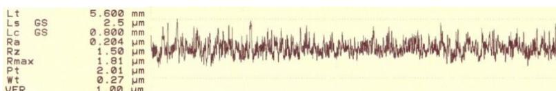
**Figura 33 - Topografia da superfície moldante do postigo macho retificado com ângulo de saída de 1°**
