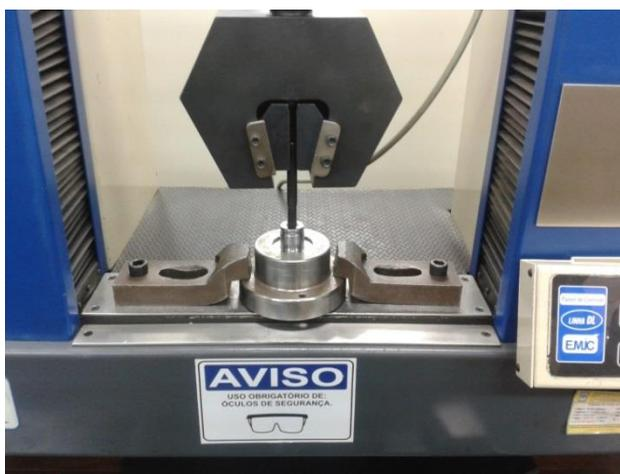
**Figura 28 – Obtenção da força de extração na máquina de ensaios de tração**
