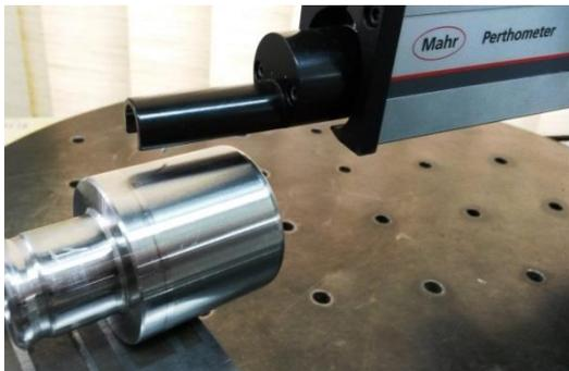
**Figura 30 - Instrumento utilizado para verificação da rugosidade dos postiços**
