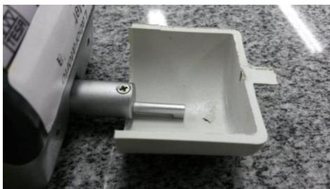
**Figura 31 - Instrumento utilizado para verificação da rugosidade das peças injetadas**
