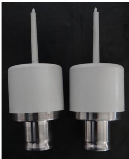
**Figura 29 - Peça plástica contraída sobre a superfície do postição macho.**
