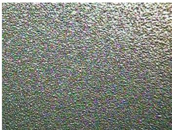
**Figura 41 - Topografia da superfície moldante com acabamento erosionado.**
