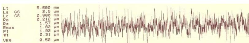
**Figura 39 - Topografia da superfície moldante do postição macho retificado com angulo de saída de 0,25°**
