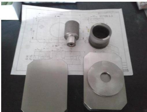
**Figura 13 - Fabricação dos componentes do molde**
