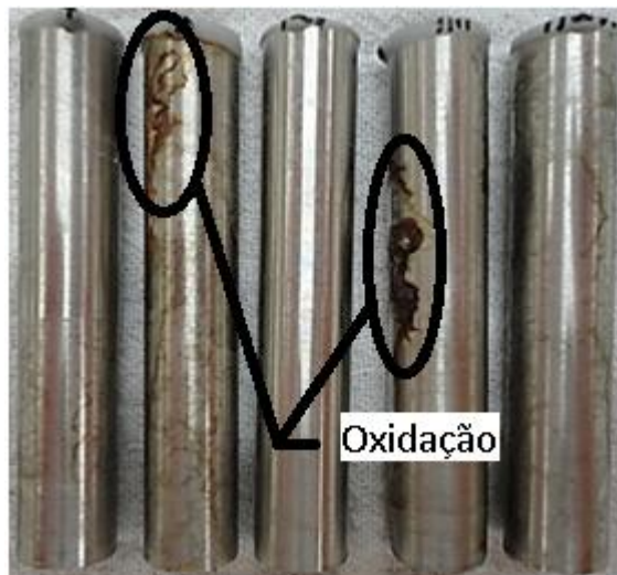
Figura 16 - Grupo A após ensaio de névoa salina Fonte: o autor(2014)
