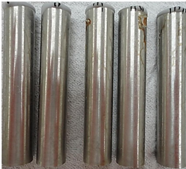
Figura 18 - Grupo C após ensaio de névoa salina Fonte: o autor(2014)
