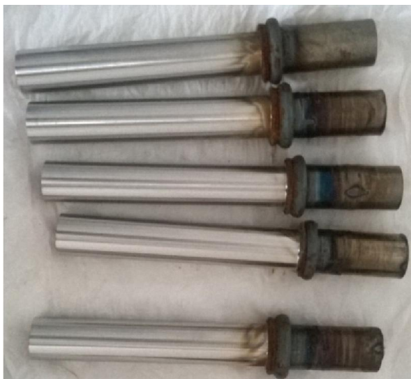
Figura 10 - Juntas dissimilares de aço inoxidável e aço-carbono Fonte: o autor(2014)
