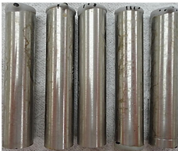
Figura 19 - Grupo D após ensaio de névoa salina Fonte: o autor(2014)
