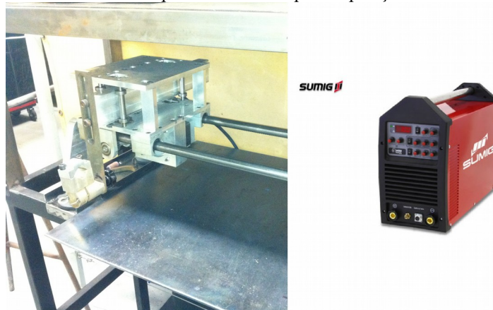
Figura 14 – Fonte e manipulador utilizado para deposição dos revestimentos
