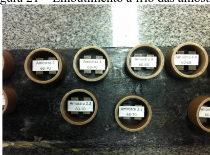
Figura 21 – Embutimento a frio das amostras
