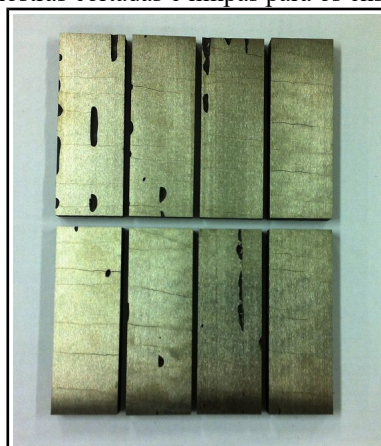
Figura 26 – Amostras cortadas e limpas para os ensaios de desgaste
