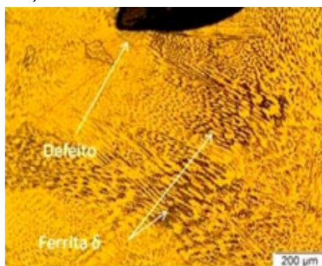
Figura 8 – Mudança na microestrutura decorrente da variação de energia
