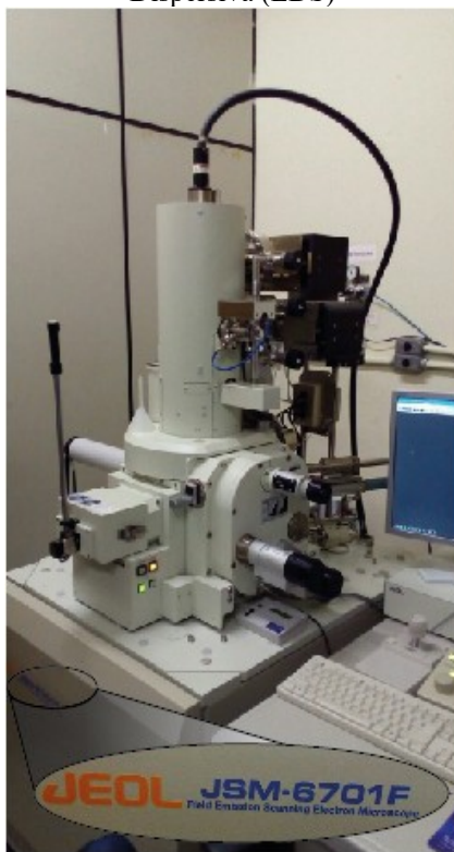
Figura 27– Microscópio eletrônico de varredura (FEG-MEV) e Espectroscopia de Energia Dispersiva (EDS)
