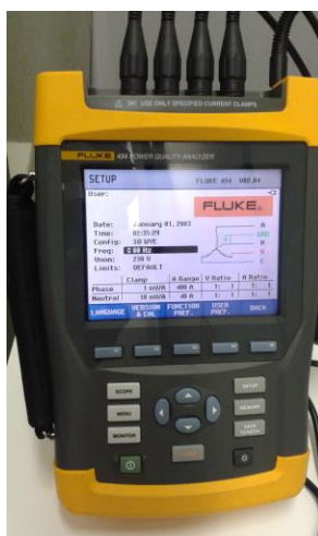
FIGURA 23 – Analisador de qualidade de energia trifásica Fluke Série 430
