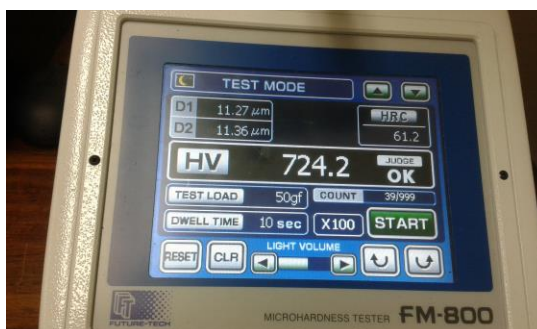
FIGURA 30 – Tela do microdurômetro mostrando os resultados dos ensaios
