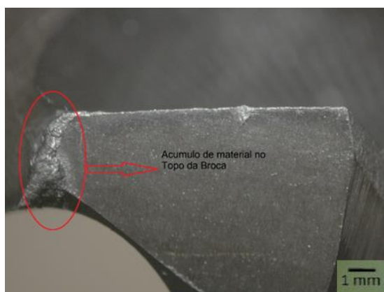
FIGURA 35 – Broca sem revestimento com acúmulo de material na ponta
