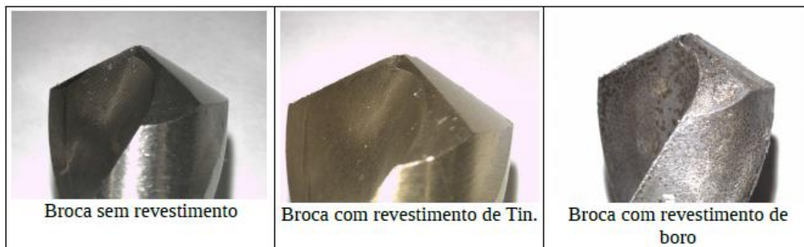
FIGURA 19 - Brocas utilizadas nos ensaios, HSS, com revestimento de TIN e de Boro
