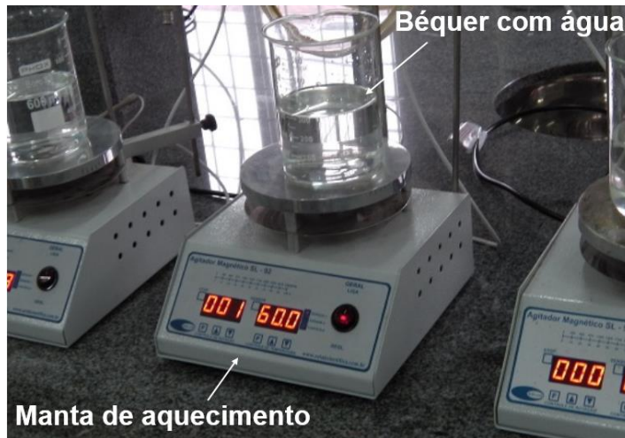
Figura 23 – Mantas ligadas para atingir o equilíbrio térmico
