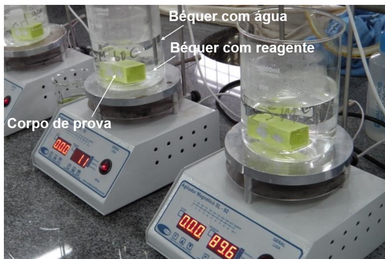
Figura 24 – Início da usinagem química
