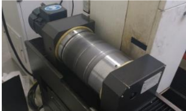
Figura 45 – Tambor de alimentação do fio da máquina de eletro erosão a fio EF.
