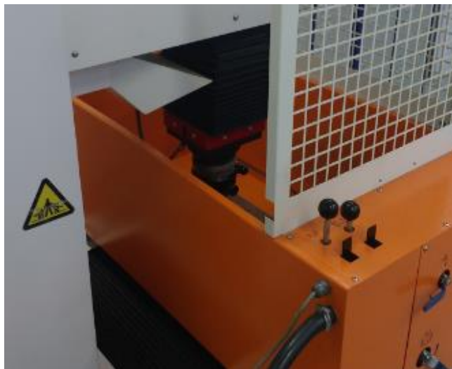
Figura 39 – Acesso à zona de risco da máquina de eletro erosão por penetração EP.
