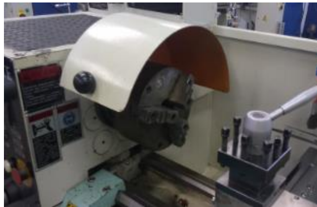
Figura 8 – Proteção parcial do torno convencional T-02.
