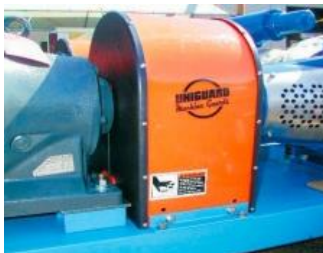
Figura 30 – Proposta de proteção para o acoplamento do motor na unidade hidráulica da retificadora plana.
