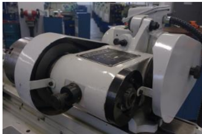
Figura 34 – Proteção do acoplamento do motor à morsa da afiadora de ferramentas A.
