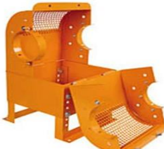
Figura 46 – Proposta de proteção para o tambor da máquina de eletro erosão a fio.
