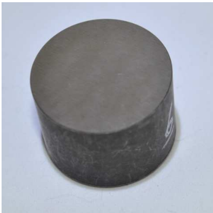
Figura 32 - Fotografia de uma peça retificada com rebolo SiC à velocidade de 12m/min
