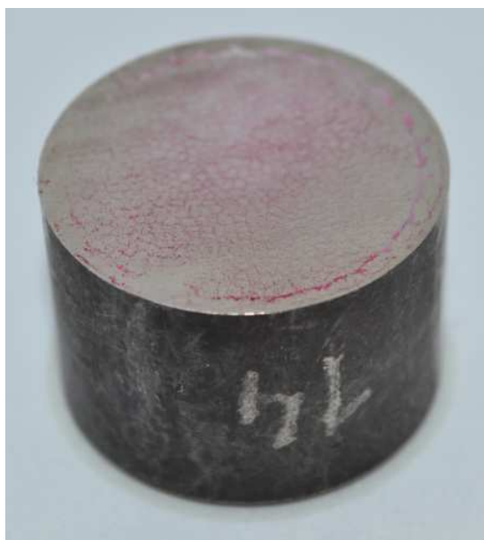
Figura 30 - Imagem após a revelação através da aplicação de líquido penetrante na superfície usinada. Retificação com rebolo de Al_2O_3 à velocidade da peça de 12m/min
