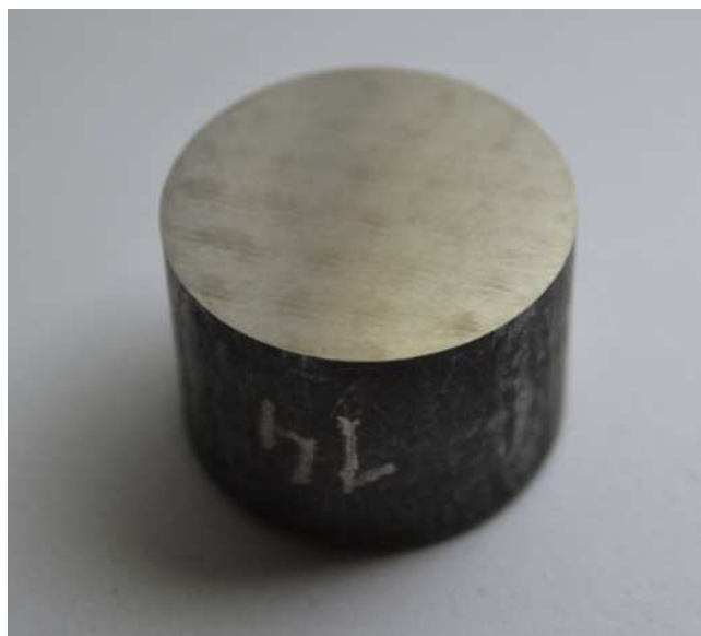
Figura 28 - Superfície com pontos de queima ocorridos após a remoção de 157,48mm 3 /mm de volume específico(V'w), utilizando o rebolo de Al 2 O 3 à velocidade da peça de 12m/min
