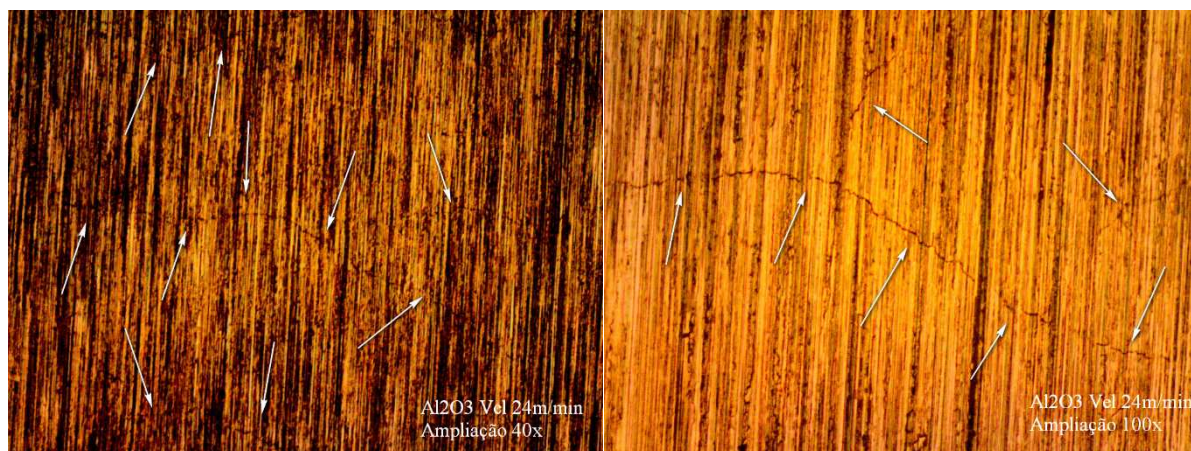
Figura 31 - Imagem ampliada 40x e 100x, superfície retificada com rebolo Al 2 O 3 à velocidade de 24m/min
