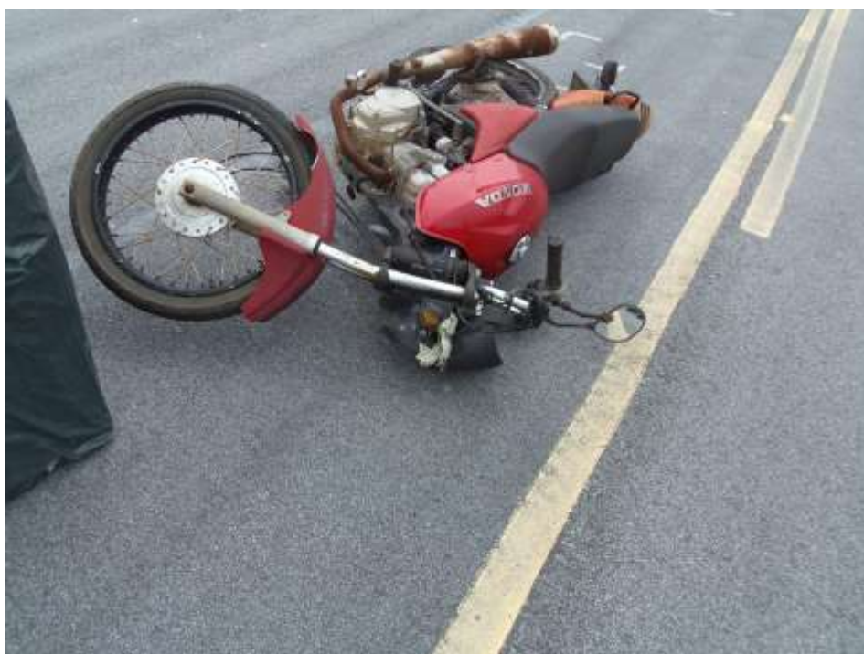
Figura 12 – Danos sistema suspensão, bengalas tortas e a posição final do veículo 01.
