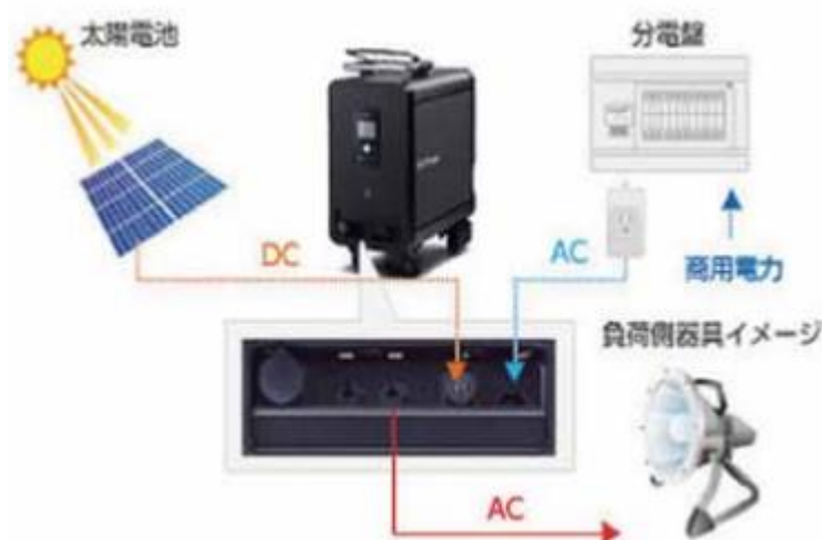
Figura 4 – Sistema de UPS fabricado no Japão com bateria de lítio e recarga por energia solar
