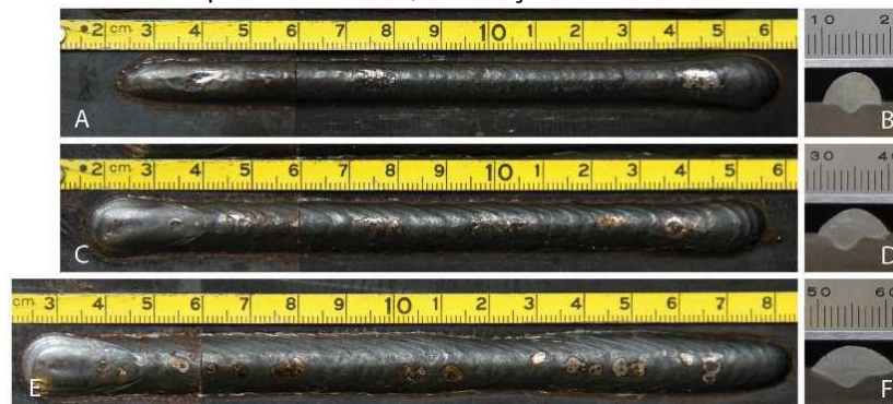
Figura 16- Resultado do uso de sincronismo: A – Cordão com polaridade CC-; B – Seção transversal do cordão A; C - Cordão com polaridades CC- e CC+; D – Seção transversal do cordão C; E – Cordão com polaridade CC+; F – Seção transversal do cordão E
