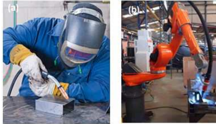
Figura 1 - Processo GMAW, em (a) manual e em (b) automático
