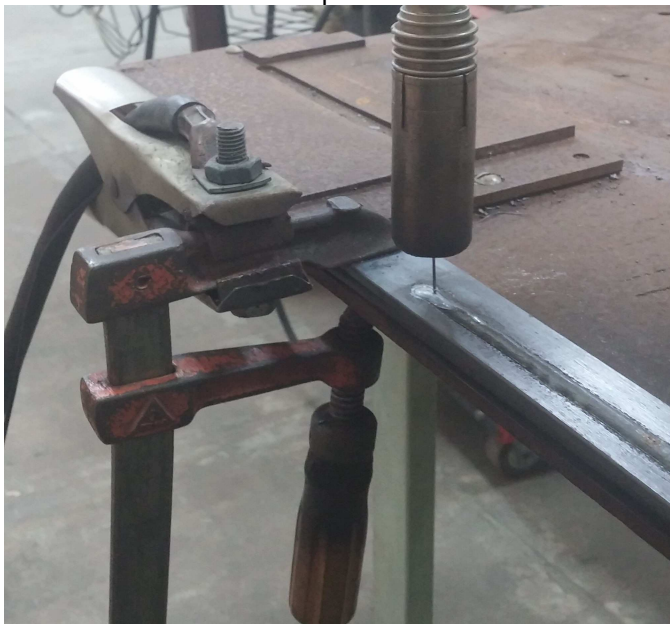
Figura 24 - Foto do ensaio realizado para determinar a corrente de transição.
