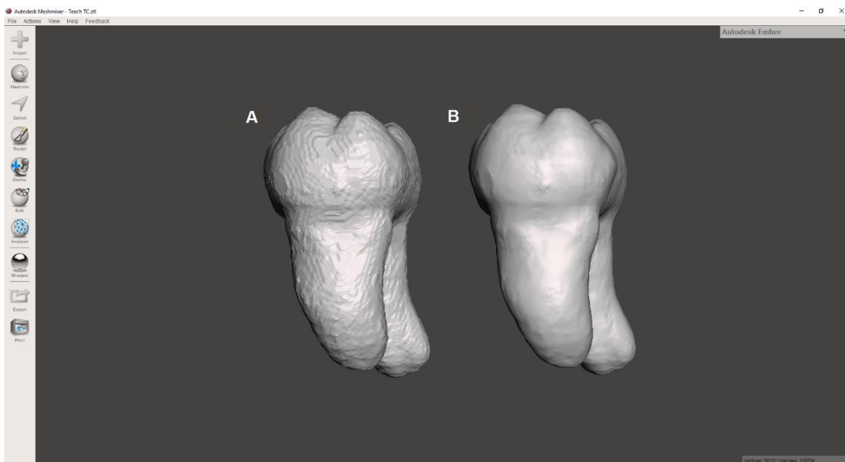
Figura 12: A) Modelo importado no Software Meshmixer; B) Aplicação do filtro "ShrinkSmooth" no modelo
