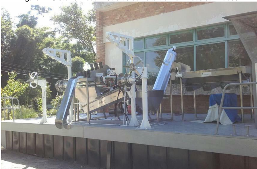
Figura 1 - Sistema mecanizado de colheita de mexilhões cultivados.
