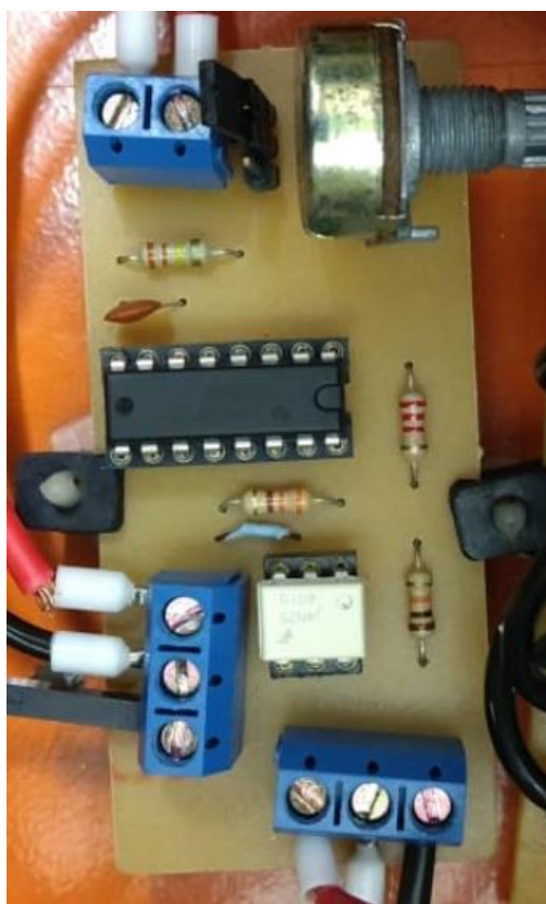
Figura 10 – Placa de tratamento de sinal.
