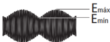
Figura 6 – Relação de máxima e mínima de tensão da onda estacionária
