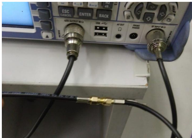
Figura 28 – Conexão dos cabos para medir o parâmetro S12
