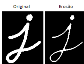
Figura 11 - Exemplo de erosão
