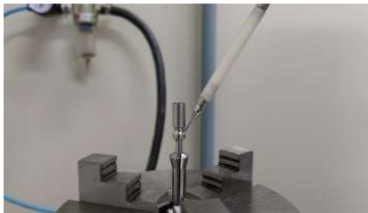
Figura 14 - Fixação da peça para medição
