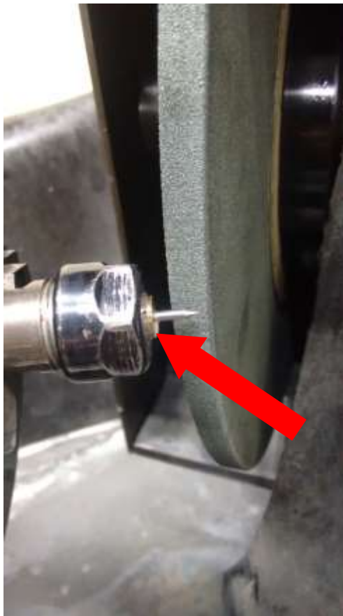
Figura 9 - Bucha para fixação das peças com o corpo maior acabado
