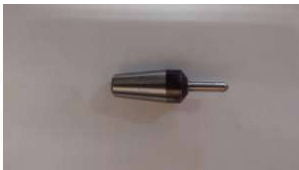
Figura 10 - Ponta intercambiável retificada
