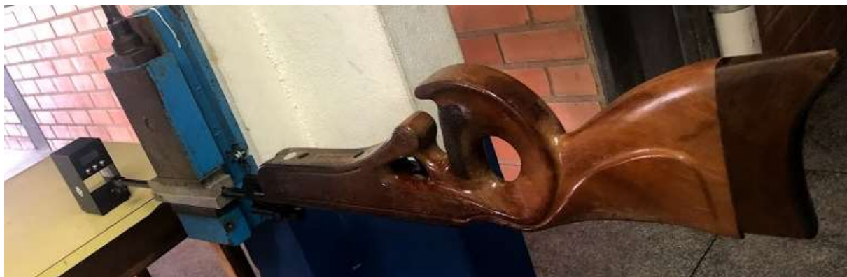
Figura 16 - Fixação da arma e posicionamento do cronógrafo
