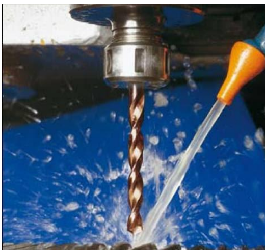
Figura 11: Aplicação de Fluido de Corte em Processo de Furação
