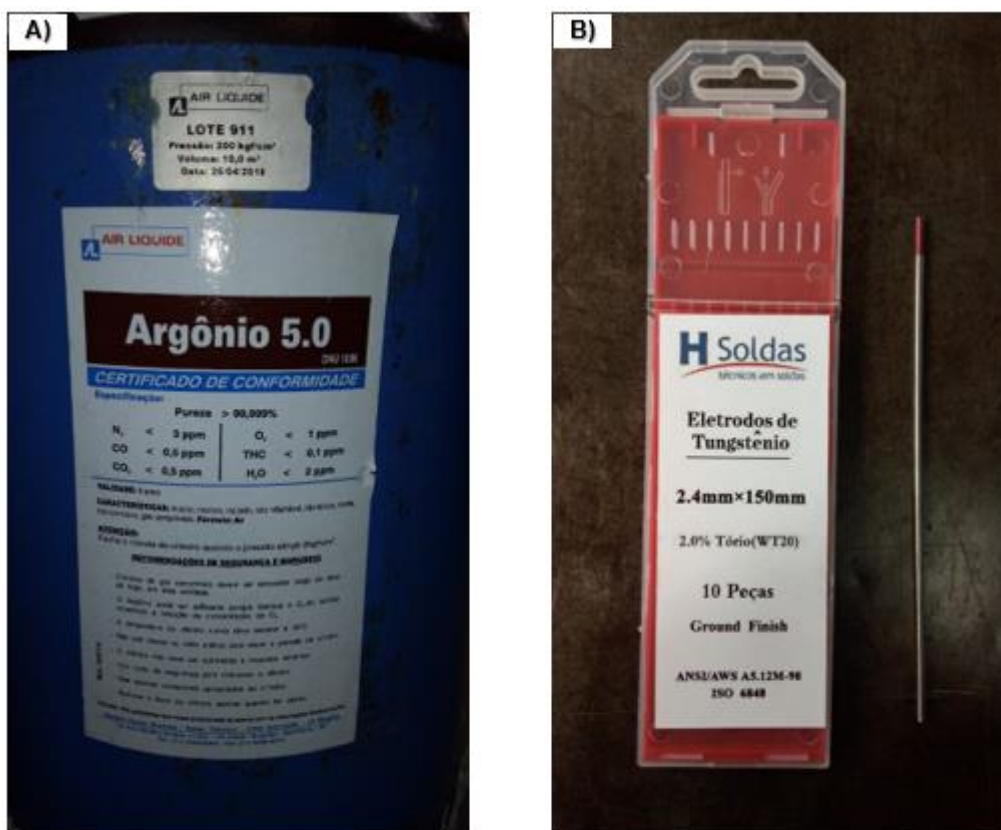
Figura A.1 – A) Argônio utilizado como gás de purga e B) Eletrodo não consumível de tungstênio
