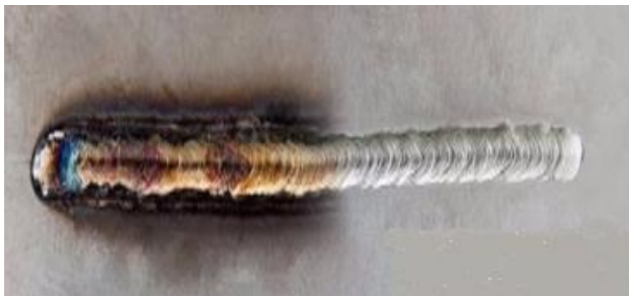
Figura 2.12 – Limpeza do cordão de solda com gel decapante e passivante
