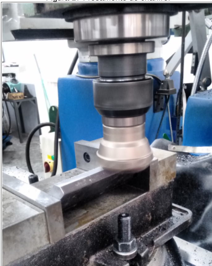
Figura 17 Fresamento do chanfro.
