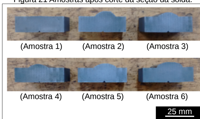
Figura 21 Amostras após corte da seção da solda.
