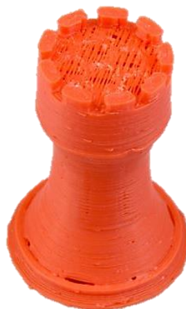
Figura 42: Camada superiores insuficientes.
