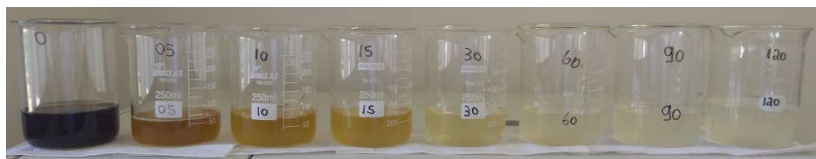
Figura 52 - Cor observada do efluente das lagoas de estabilização submetido ao processo UV/H 2 O 2 otimizado na corrida cinética.
