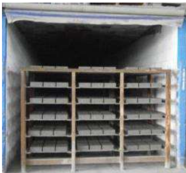
FIGURA 21 - Câmara de cura térmica
