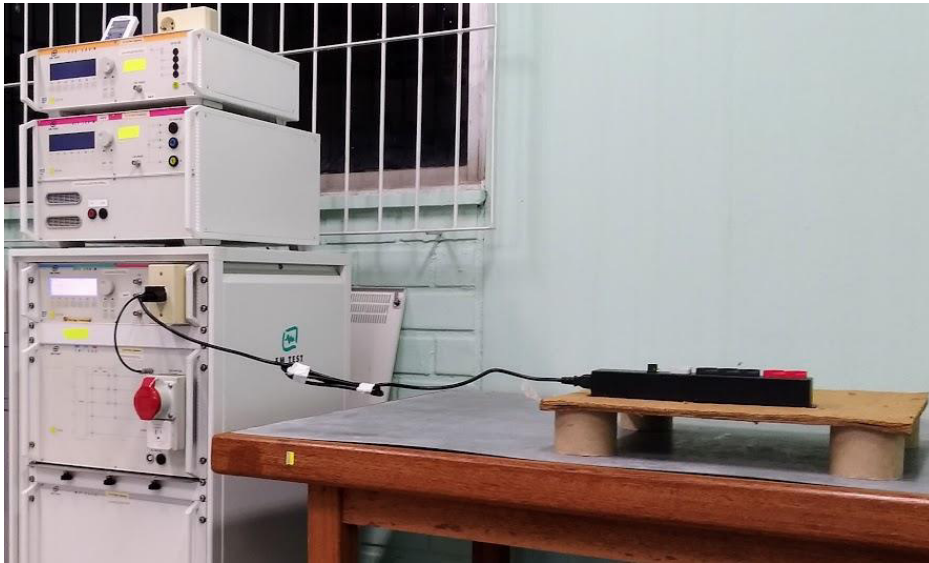
Figura 54 – Foto dos cenários de teste para IEC61000-4-4 e IEC61000-4-5.
