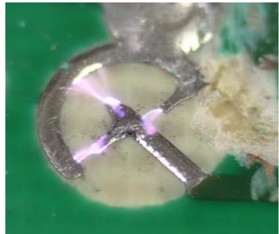
Figura 34 - Detalhe do faiscador a ar em ação com alta tensão.
