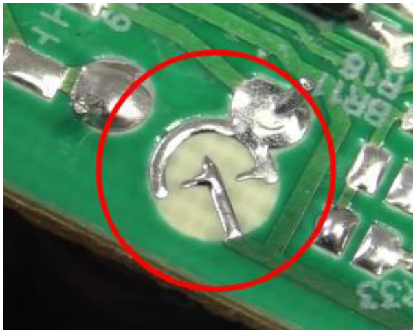
Figura 33 - Detalhe do faiscador a ar no círculo impresso na própria placa.
