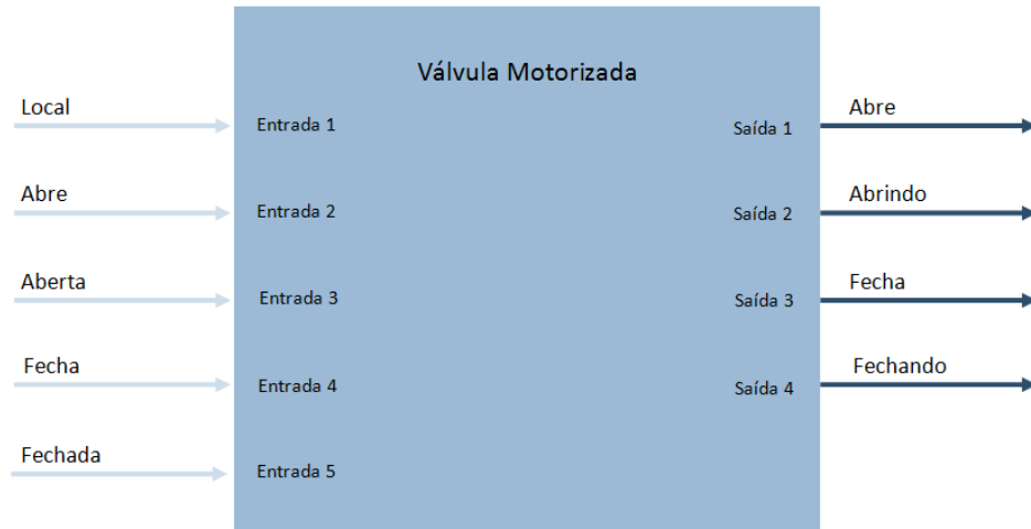
Figura 26 - Modelamento da válvula motorizada
