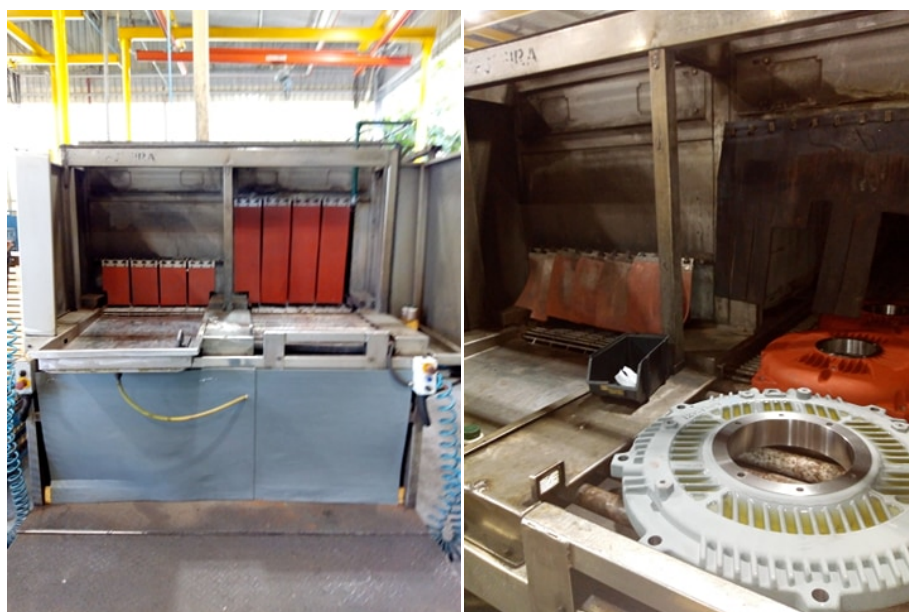
Figura 5 – Peças na saída da máquina parando sob o sensor.
