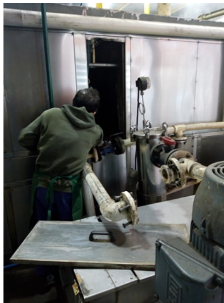
Figura 10 – Operador realizando a alteração da posição da faca de ar.
