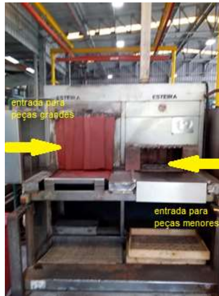
Figura 3 – Entrada da Máquina de Lavar Peças usinadas.
