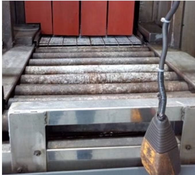
Figura 14 – Proteção fixa com vazio ao centro.
