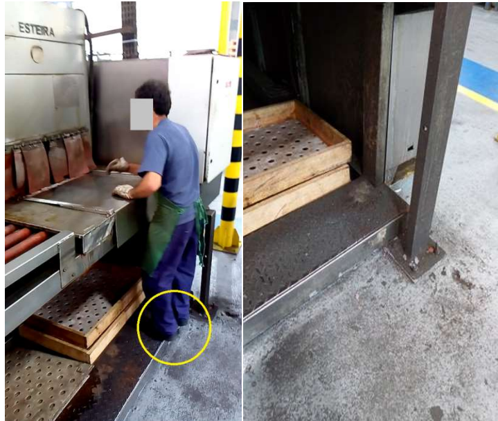
Figura 11 – Operador colocando peças na máquina sobre a base.
