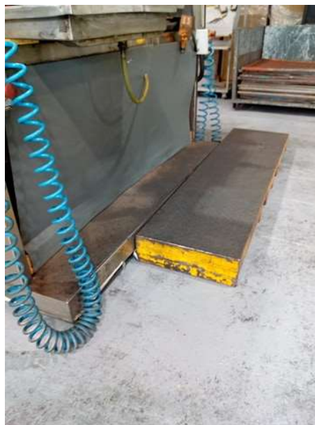
Figura 12 – Base fixa e base móvel sem fixação.
