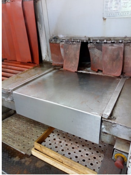
Figura 17 – Placa lisa, posicionada com grau e fixada à máquina.
