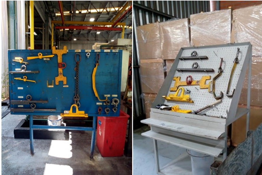
Figura 8 – Suporte para os dispositivos utilizados no içamento das peças.
