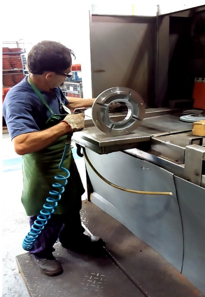
Figura 6 – Operador retirando o excesso de água restante após a lavagem.
