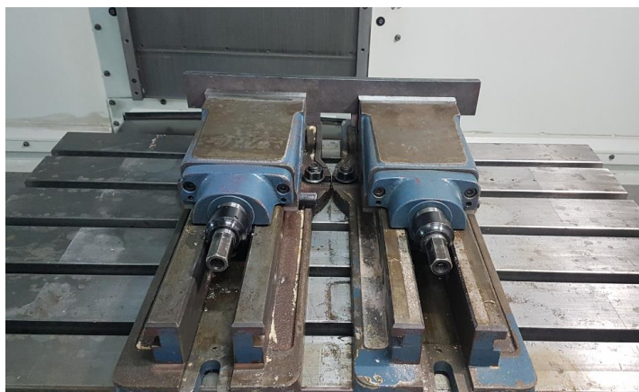
Figura 17 – Método de fixação do corpo de prova
