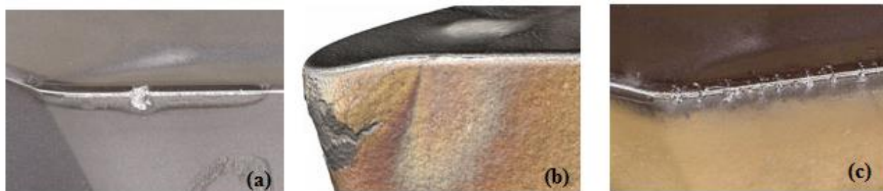
Figura 4 – Exemplo de avaria de quebra (a), de trinca (b) e de sulco (c)
