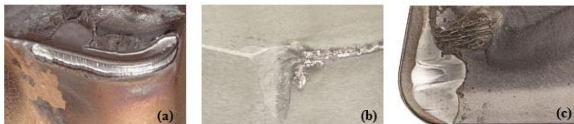
Figura 5 – Exemplo desgaste de flanco (a), desgaste de entalhe (b) desgaste de cratera (c)
