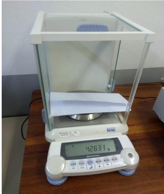
Figura 18 - Balança de precisão utilizada no ensaio de molhabilidade
