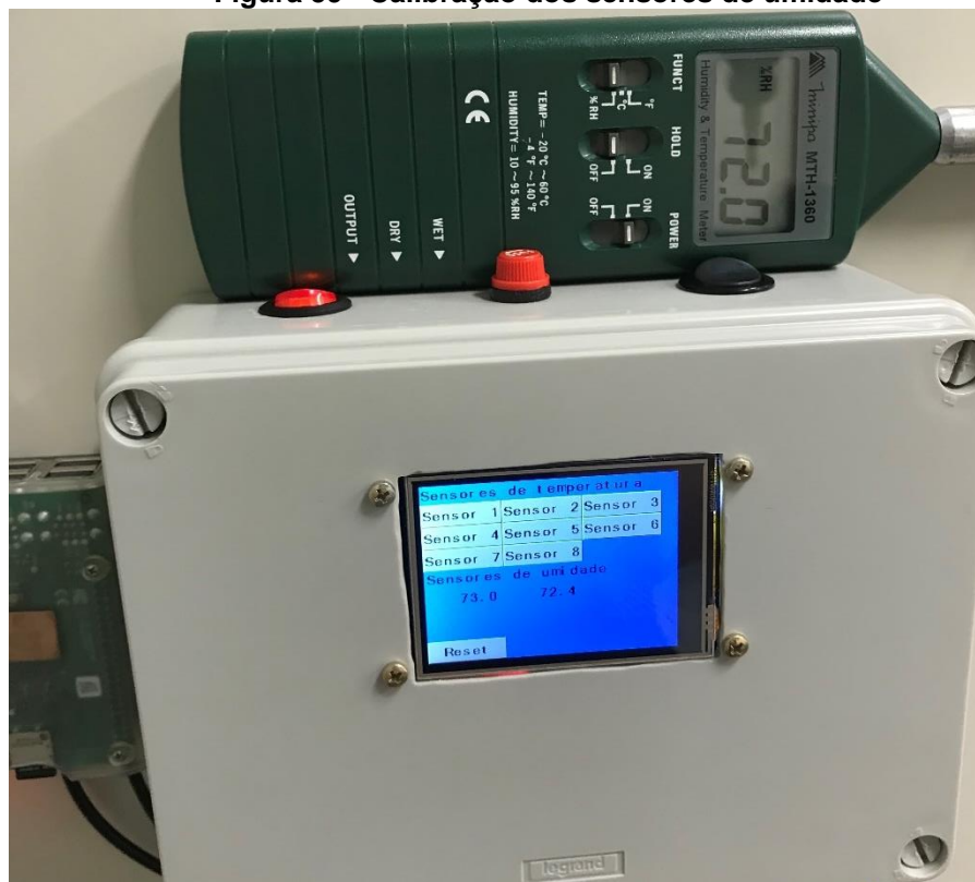
Figura 59 - Calibração dos sensores de umidade
