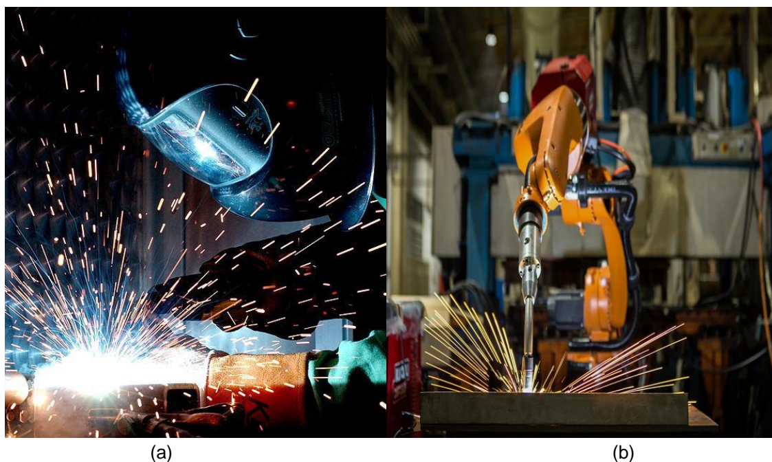
Figura 1 - Processo GMAW, em (a) manual e em (b) automático
