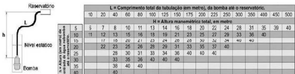
Figura 29: Altura equivalente da bomba em razão da altura h pela altura manométrica
