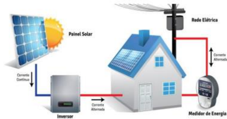
Figura 9: Funcionamento sistema on grid
