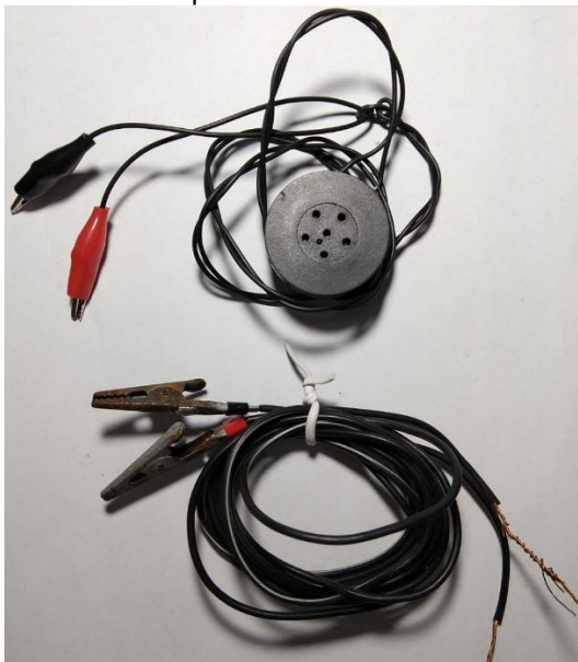
Figura 15 - Fone de alta impedância foi retirado de sucatas de orelhão
