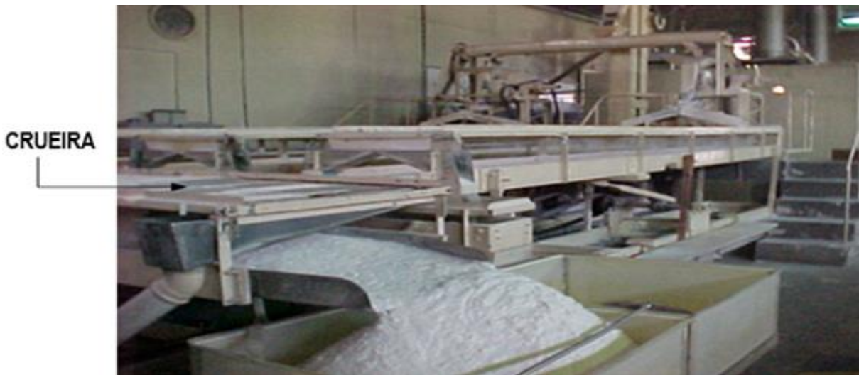
Figura 2 – Separação da farinha e crueira
