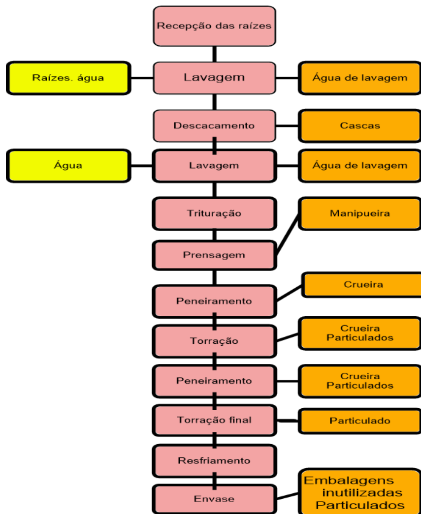
Figura 1 - Fluxograma do processo de beneficiamento da mandioca para obtenção de farinha.
