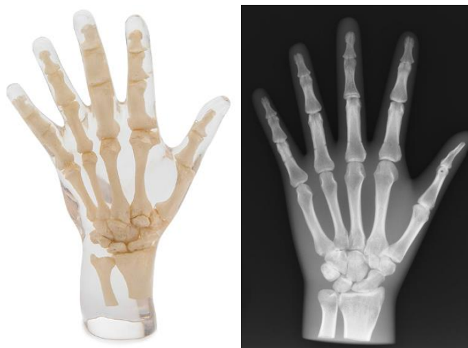
Figura 8 – Phantom antropomórfico de mão e sua respectiva imagem radiográfica
