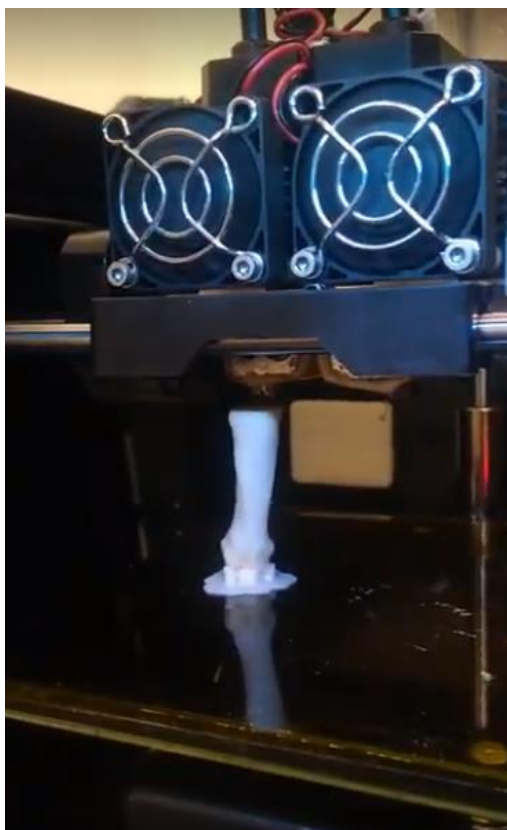
Figura 27 – Impressão de um metacarpo
