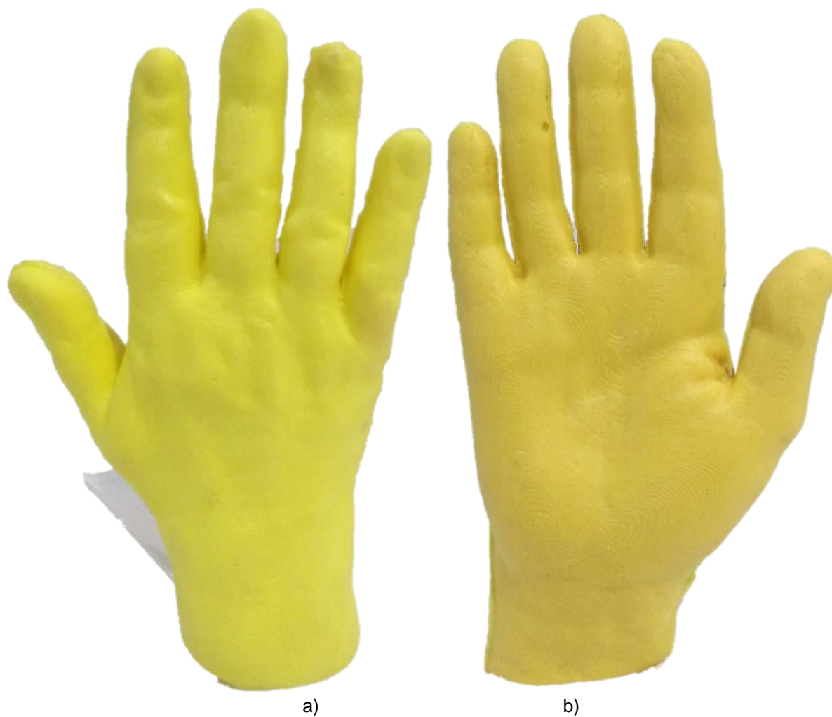
Figura 34 – Protótipo do Phantom: a) Dorso da mão; b) Palma da mão
