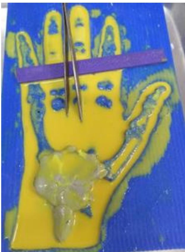
Figura 31 – Lado A com mistura de poliuretano e molde ósseo posicionado
