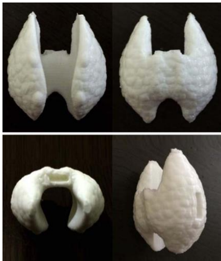
Figura 9 – Phantom antropomórfico de Tireoide
