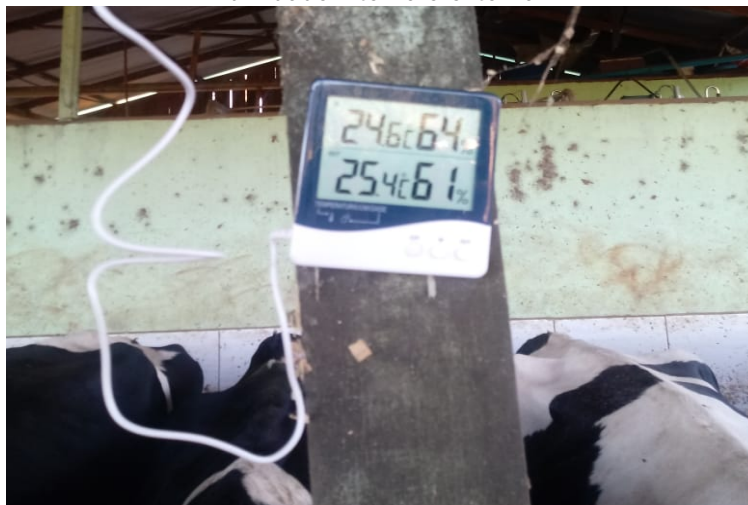
Figura 6. Termohigrômetro apresentando respectivos dados de temperatura e umidade interna e externa.
