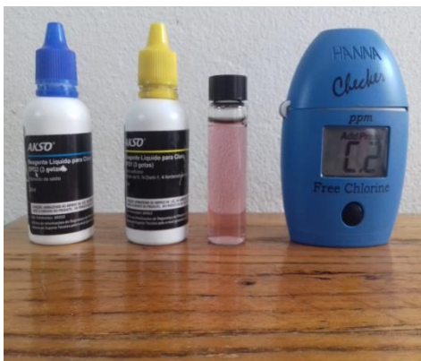
Figura 4 Determinação do teor de cloro residual.
