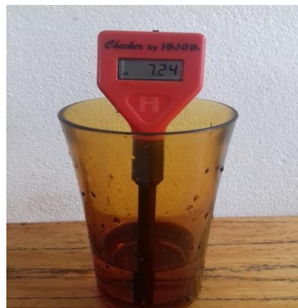
Figura 5 Determinação de pH da água
