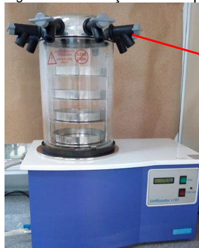
Figura 11: Ilustração da tampa e torneiras.
