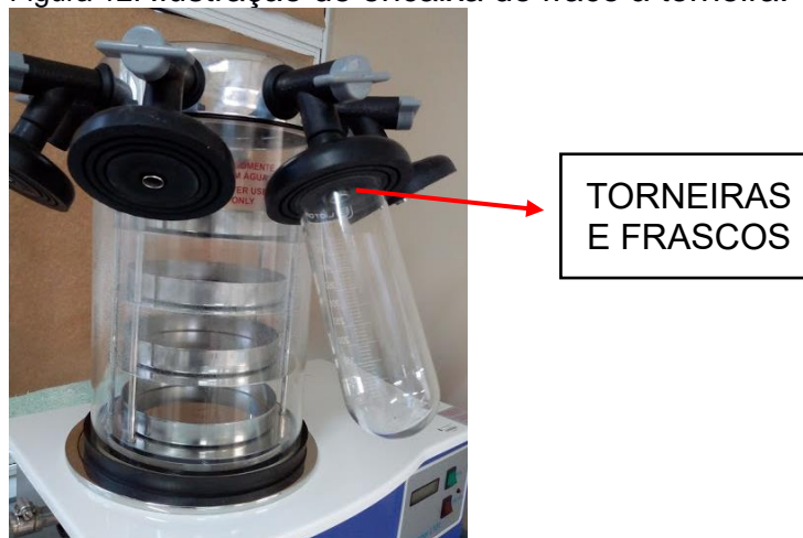
Figura 12: Ilustração de encaixa do frasco à torneira.
