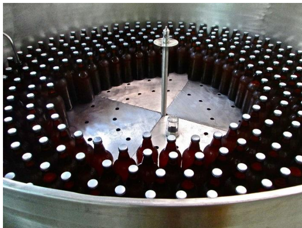
Figura 2: Vista interna do pasteurizador de cerveja
