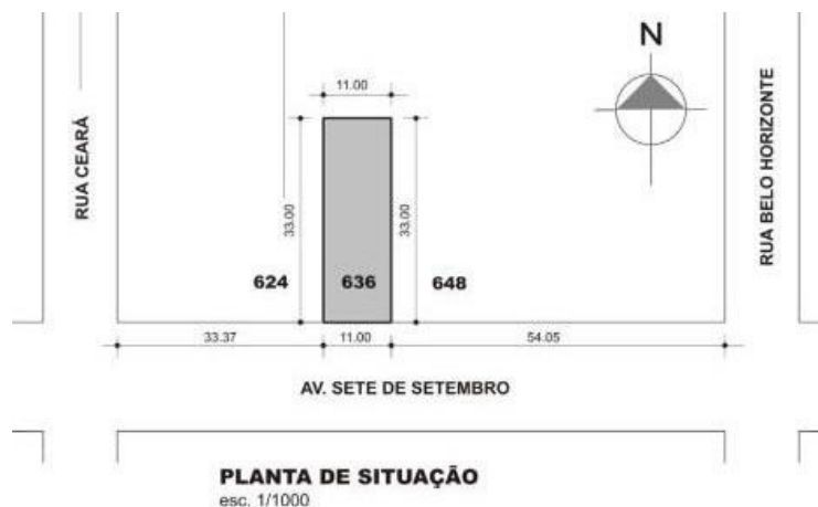
Figura 3 – Exemplo de planta de situação
