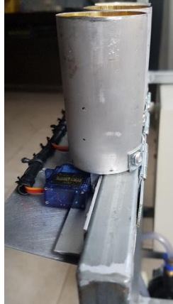
Figura 14 - Mecanismo de lupulagem
